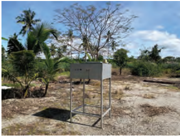
รูปที่ 3.4 การติดตั้งเครื่องเก็บน้ำฝนในพื้นที่เกษตรกรรมโดยรอบรัศมี 5 กิโลเมตรของนิคมอุตสาหกรรมดับบลิวเอชเอ อีสเทิร์นซีบอร์ด 2
