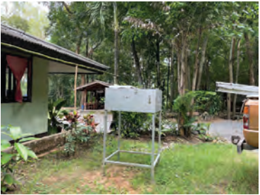
รูปที่ 3.5 การติดตั้งเครื่องเก็บน้ำฝนในพื้นที่ป่าไม้โดยรอบรัศมี 5 กิโลเมตรของนิคมอุตสาหกรรมดับบลิวเอชเอ อีสเทิร์นซีบอร์ด 2
