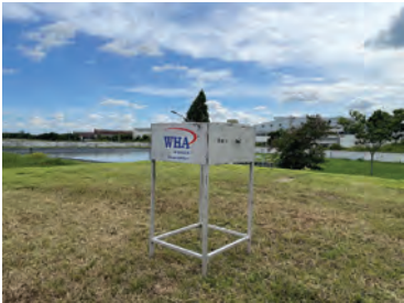
รูปที่ 3.2 การติดตั้งเครื่องเก็บน้ำฝนและการเก็บตัวอย่างน้ำฝนในพื้นที่นิคมอุตสาหกรรมดับบลิวเอชเอ อีสเทิร์นซีบอร์ด 2
